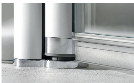
Der kraftvolle Hebe-Senk-Mechanismus hebt die Türen beim Öffnen um 5mm an und verhindert somit ein Schleifen der Dichtprofile auf dem Boden. Der Türflügel kann über den Hebe-Senk-Mechanismus in verschiedenen Positionen fixiert werden.
