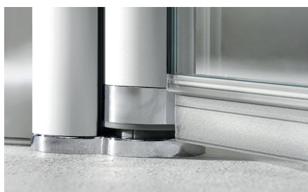
Der kraftvolle Hebe-Senk-Mechanismus hebt die Türen beim Öffnen um 5mm an und verhindert somit ein Schleifen der Dichtprofile auf dem Boden. Der Türflügel kann über den Hebe-Senk-Mechanismus in verschiedenen Positionen fixiert werden.
