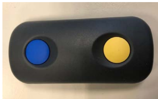
Bisheriger Funksender (433 MHz) durch neuen Funksender (868 MHz) ersetzen.
